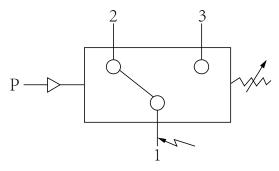
单刀双掷微动开关作用过程: 接线端 1-3 压力上升至上切换值接通; 接线端 1-2 压力上升至上切换值断开。
