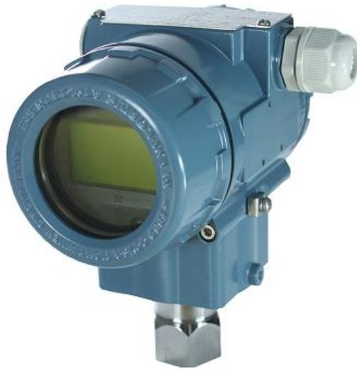
TX3351-GP&AP 压力变送器用于测量液体、气体或蒸汽的液位、密度、压力，然后将其转变成 4~20mA DC HART 电流信号输出。TX3351-GP&AP 也可与 RST375 手持终端或 RSM100 Modem 相互通信，通过它们进行参数设定、过程监控等。
