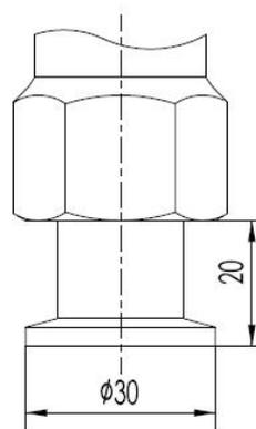
1/4 英寸 NPT 外螺纹 (代码 6)
